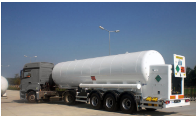
Abbildung 29: Semi-Trailer für den CO 2 -Transport
