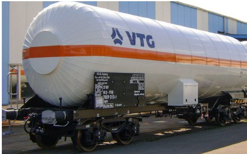
Abbildung 27: Flüssiggas-Kesselwagen für den CO 2 -Transport
