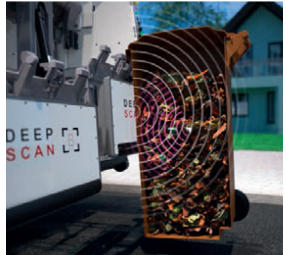
Störstofferkennung im Biomüll, Quelle: ZOELLER
