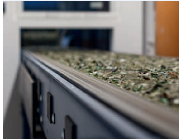
Glas in der Sortierung, Quelle: Reiling
