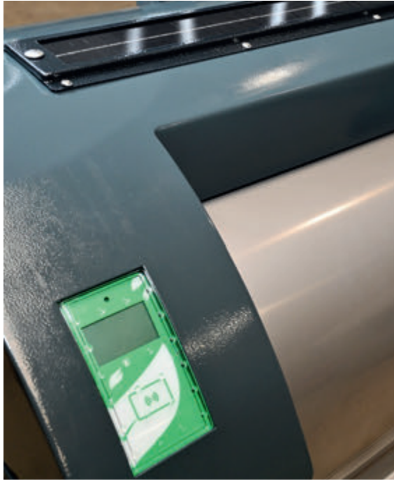
Zugangskontrolle mit Solarpanel, Quelle: newwaste
