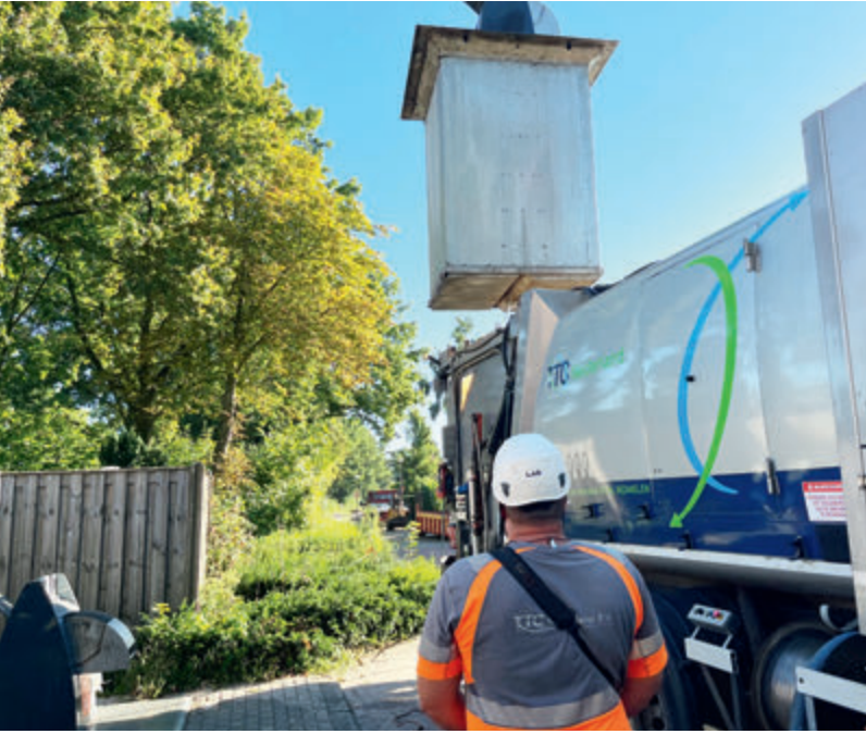
Reinigung von Unterflurbehältern, Quelle: Breer
