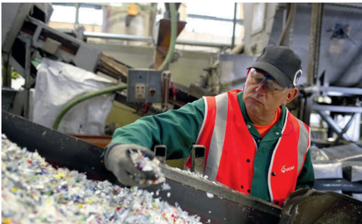
Aufbereitung von HDPE-Abfällen aus Haushalten, Industrie und Gewerbe, Quelle: Veolia
